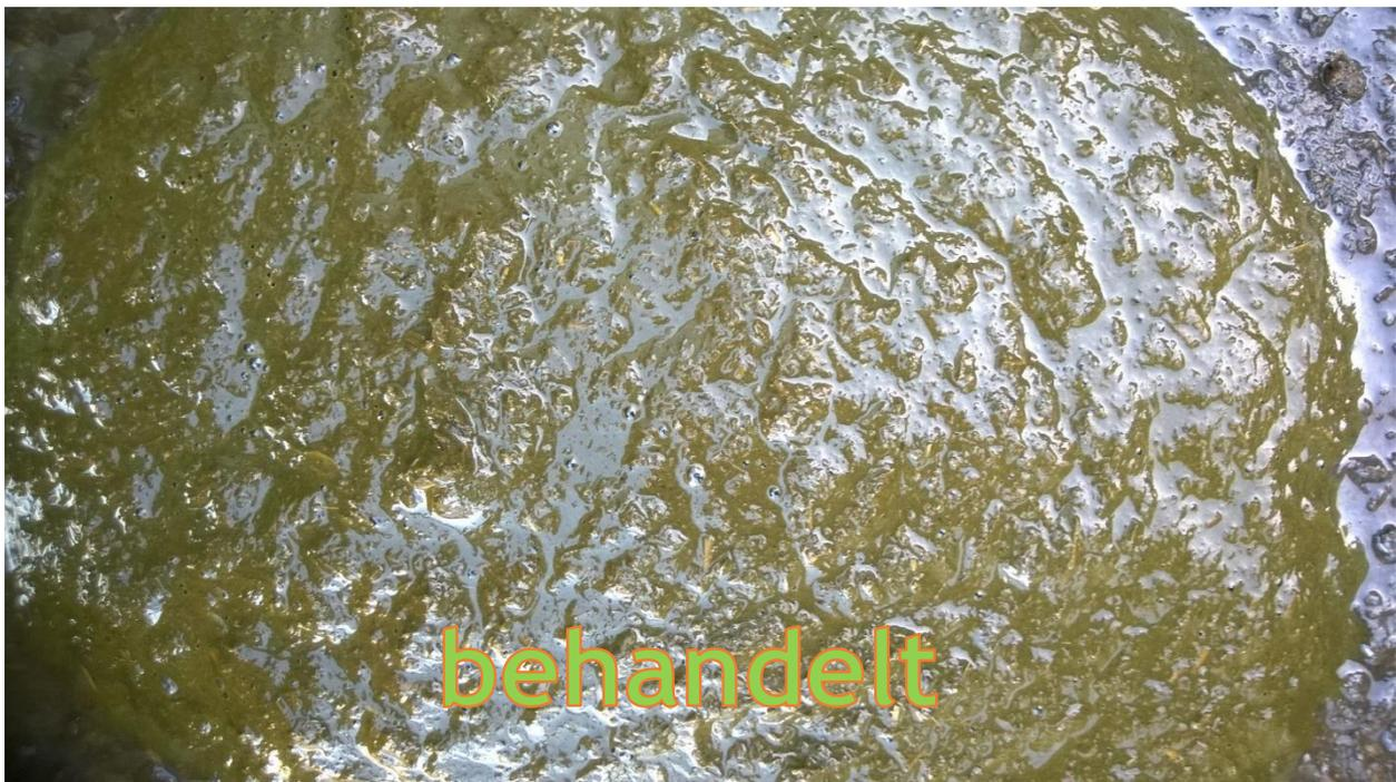
Das heißt das Material wird mit einer einzigen Behandlung durch „bewusst herbeigeführte Kavitation“ (kontrollierte Kavitation) aufgeschlossen. Nicht das flüssige, sondern die Faser und feste durch die Bakterien nicht erreichbare Fraktionen werden in Ihre Bestandteile zerlegt sodass diese von den Bakterien direkt erreicht und umgesetzt werden können. Unmittelbar hiernach kommt es zur Methanproduktion.
