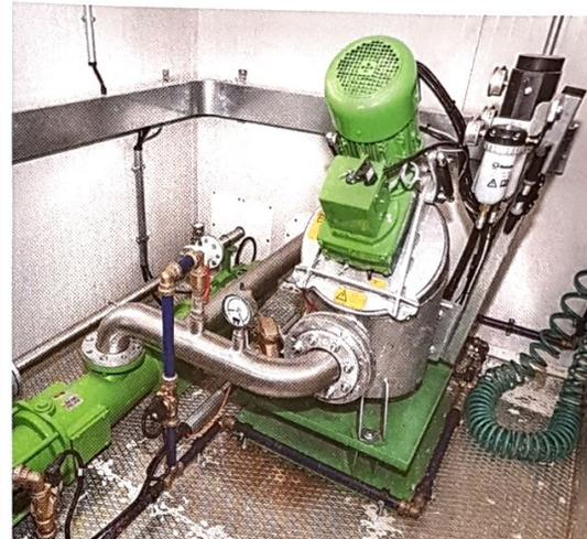
Der Rotor im Kavitator wird von einem 75 kW starken Elektromotor angetrieben (Bild links).
