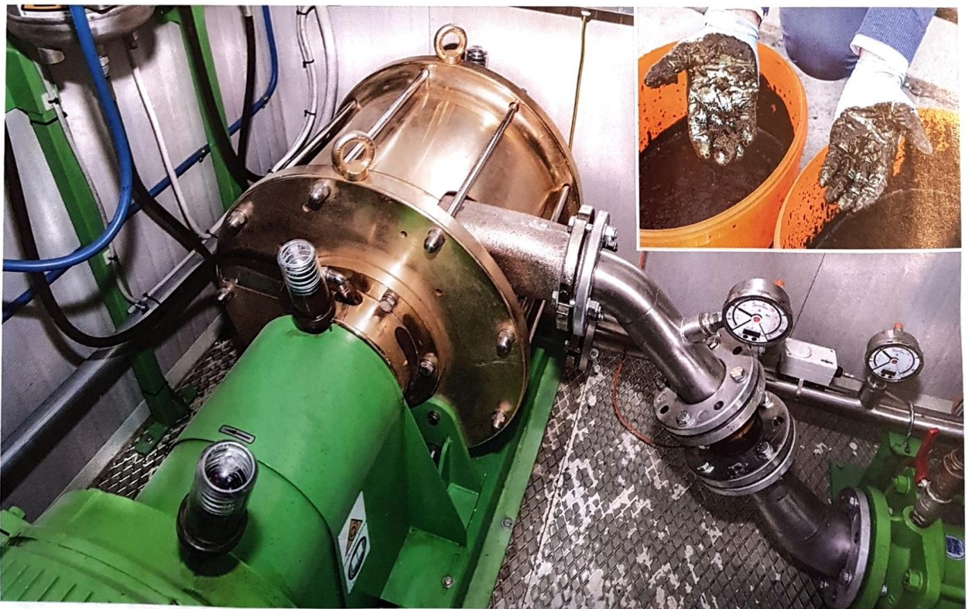
Der in dem vergoldeten Gehäuse eingebaute Rotor ist das Herzstück der BioBang-Anlage von Three-Es. Er zerstört Zellwände. Fotos: Touornik
